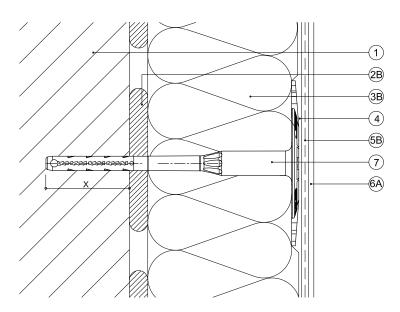
X ..... Distancia que depende del muro y del tipo de anclaje utilizado
